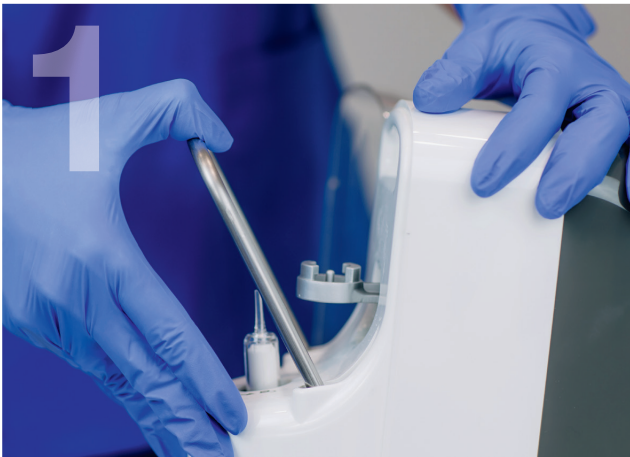
1. Mit dem Hebel aktivieren
